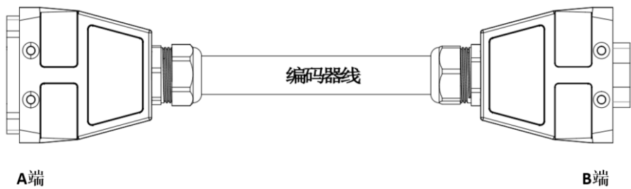
图 9-10 ARC4-50/ARC4-75/ARC4-165 编码器线示意图
