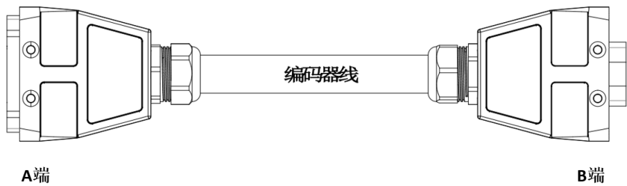
图 9-17 ARC5-280 柜外编码器线束示意图
