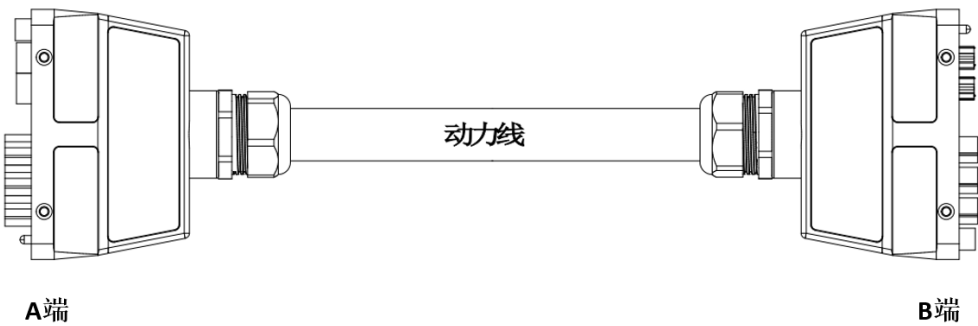
图 9-12 ARC4-50/ARC4-75 动力线示意图
