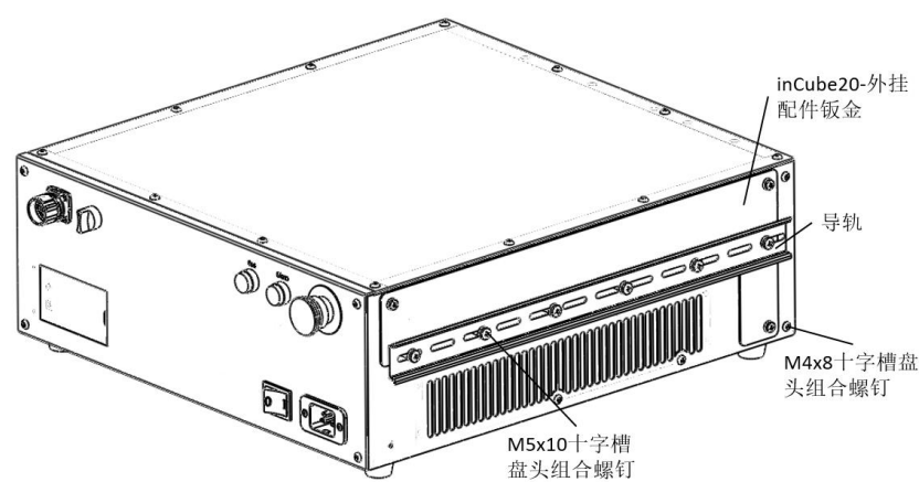
图 16-3 安装 inCube20-外挂钣金与导轨
