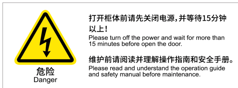
图 1-7 开门断电&维护指示牌
