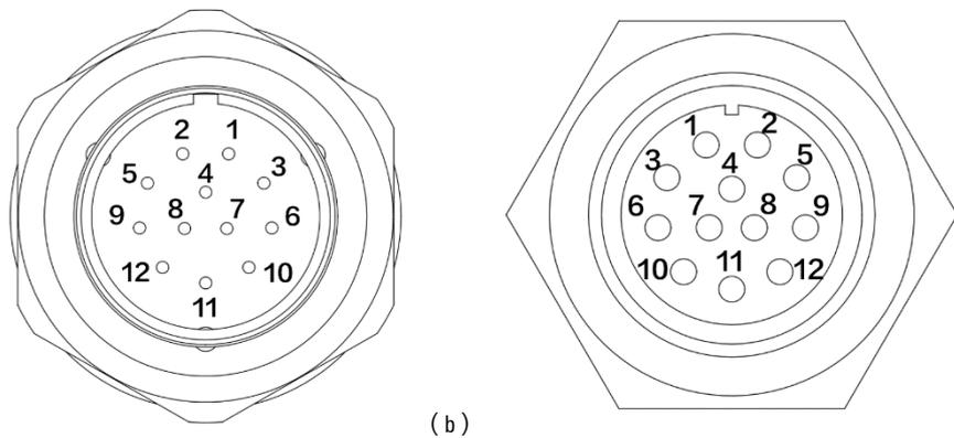
图 4-8 AIR50-2230B 操作机底座 I/O 航插接口（左）及小臂 I/O 航插接口（右）
