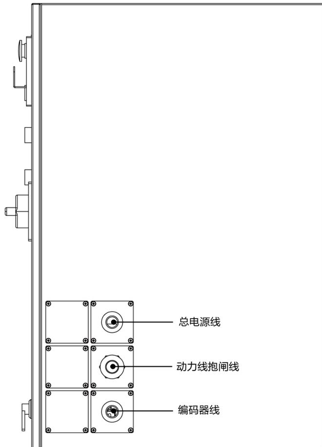
图 5-1 AIR50-2230B 控制柜线缆连接器定义
