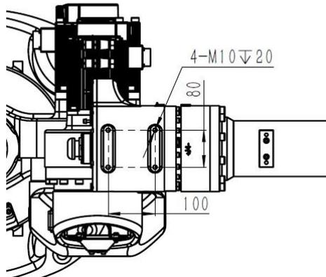
图 6-11 AIR50-2230B 肘部负载接口尺寸示意图
