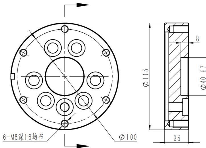
图 6-7 AIR50-2230B 腕部法兰尺寸示意图
