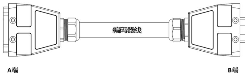
图 4-4 ARC4-50 编码器线示意图
