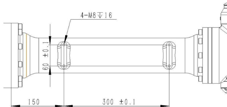
图 6-12 AIR50-2230B 小臂接口尺寸图
