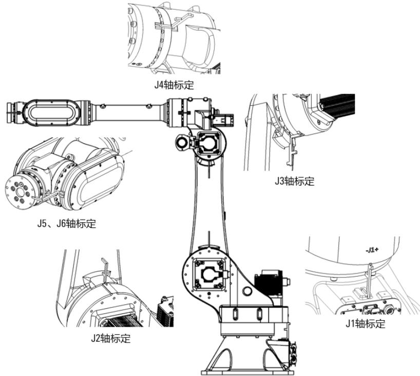
图 6-5 零点标定块标定方式
