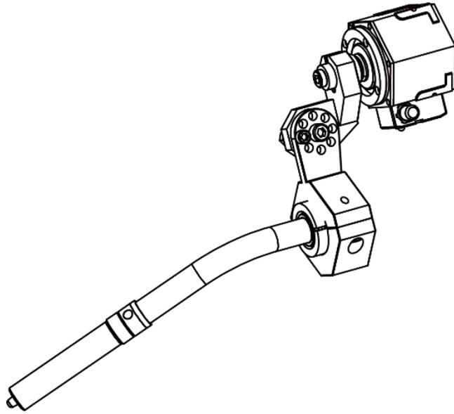
图 5-10 工业机器人用弧焊枪
