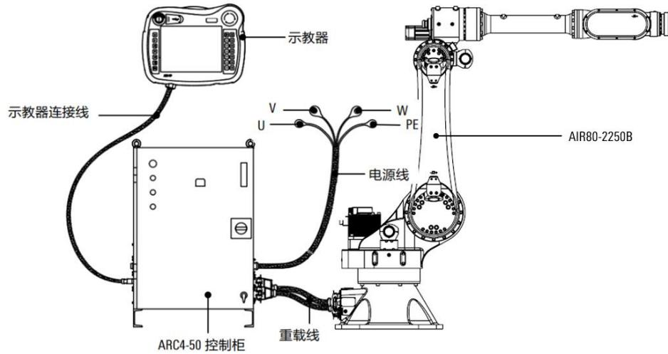
图 5-5 工业机器人系统接线概览
