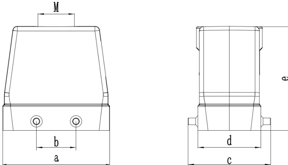
图 4-5 编码器线重载接头尺寸
