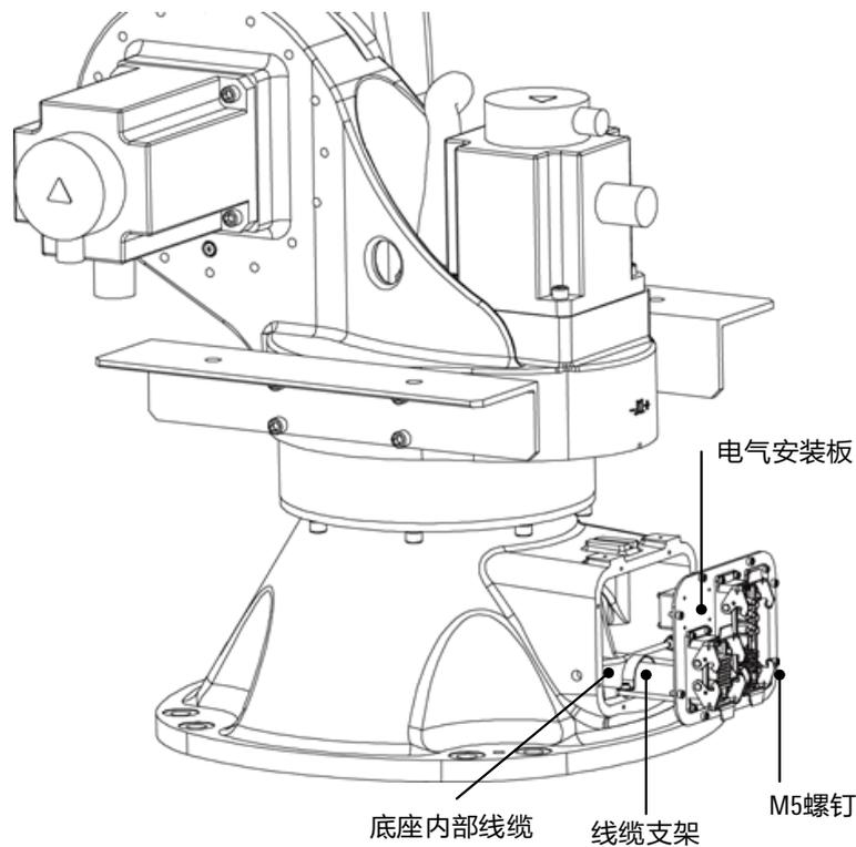
图 10-2-A 底座内部线缆组成示意
