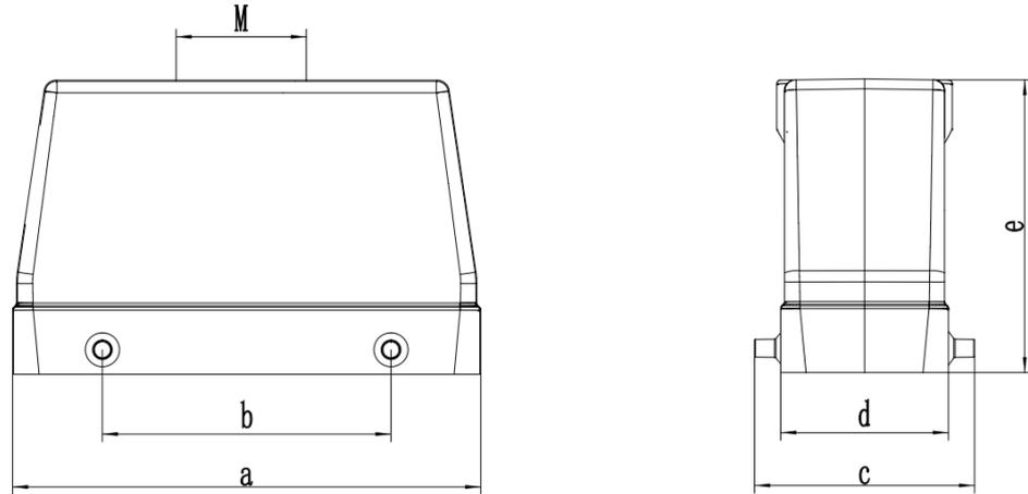
图 4-7 动力线重载接头尺寸
