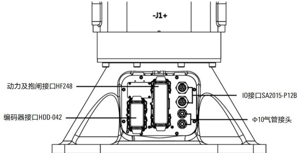
图 4-1 AIR50-2230B 操作机本体底座接口
