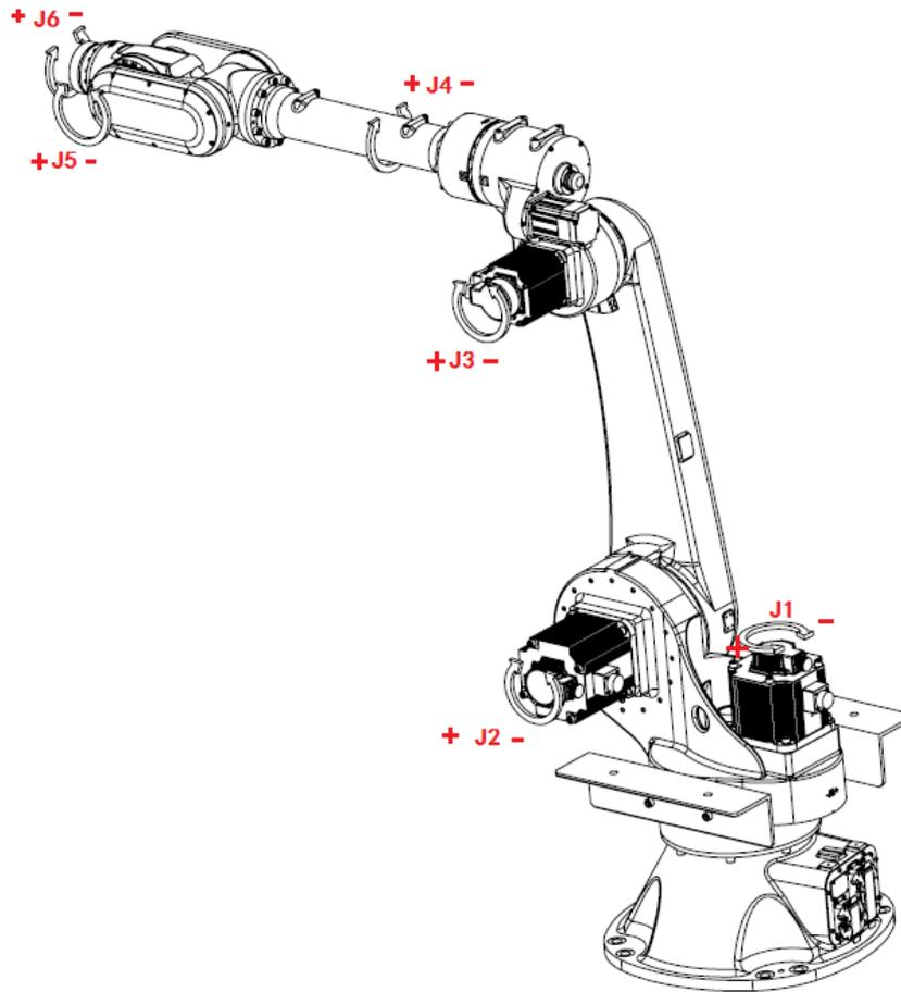
图 6-6 操作机各轴的运动方向
