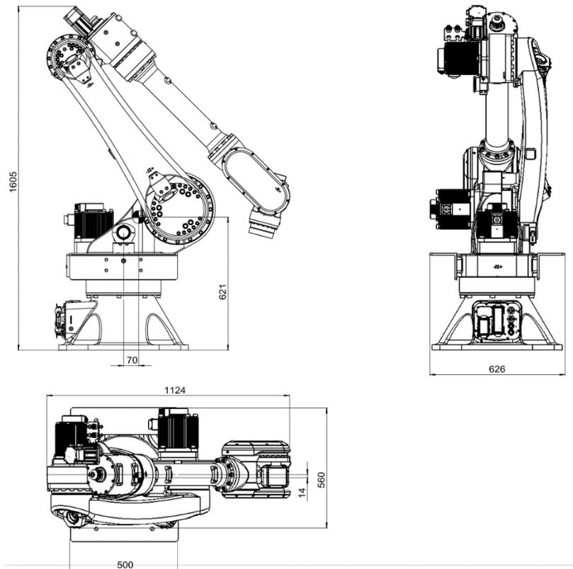
图 7-3 AIR50-2230B 搬运时操作机尺寸
