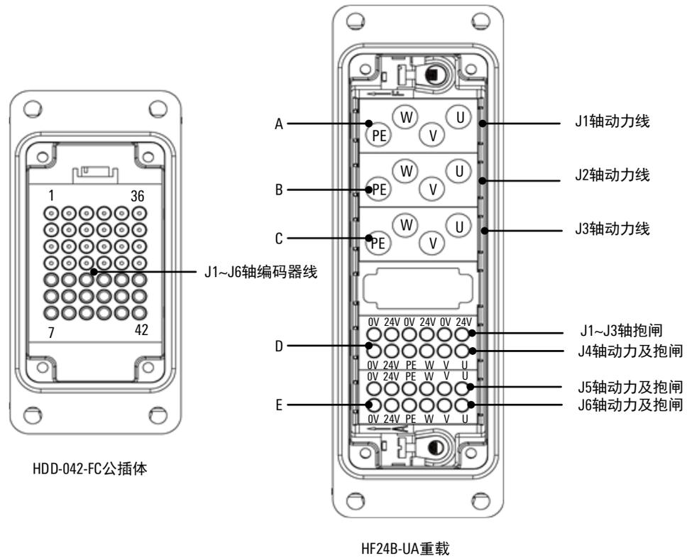
图 4-3 AIR50-2230B 操作机重载接口定义
