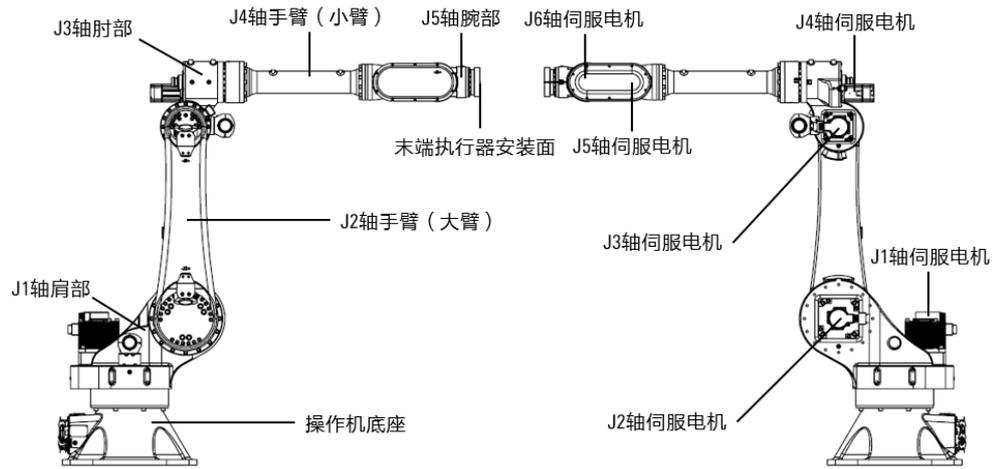
图 2-2 AIR50-2230B 机器人本体及其各个部分示意图
