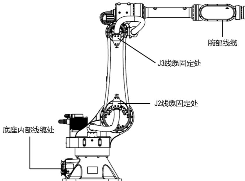
图 10-1 操作机线缆布局图
