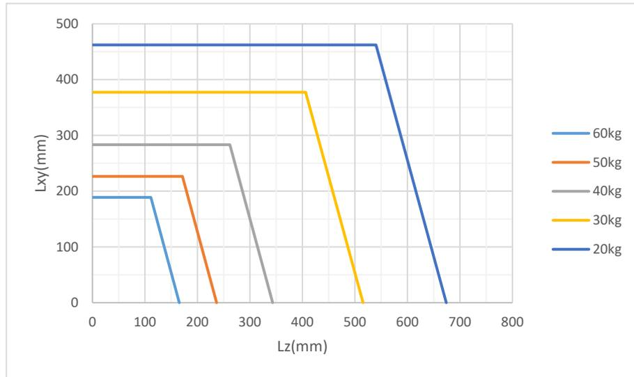
图 6-9 AIR50-2230B 腕部负载质心位置示意图
