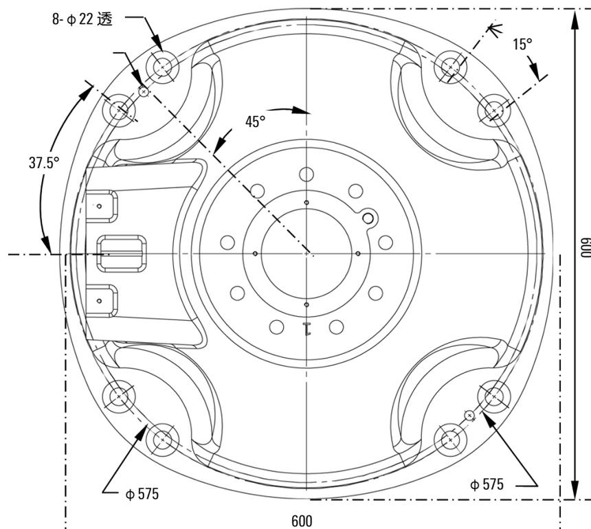
图 3-3 AIR50-2230B 操作机底座接口尺寸
