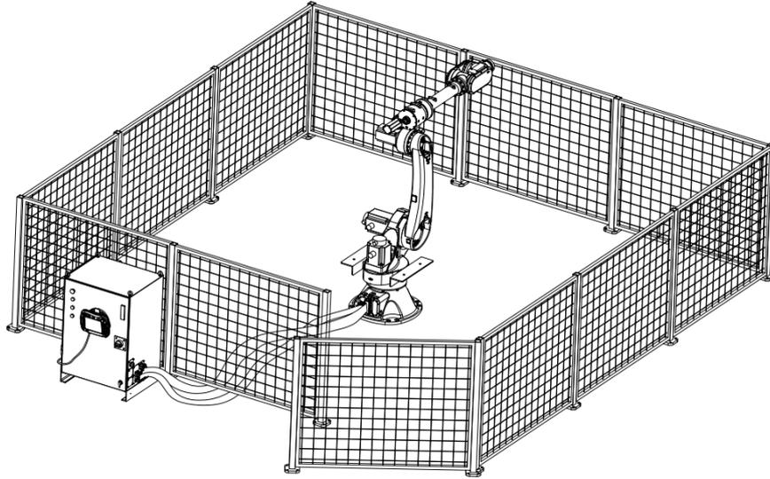
图 3-1 工业机器人安全工作示意图
