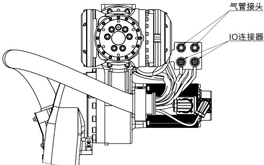
图 4-2 AIR50-2230B 操作机本体三轴接口
