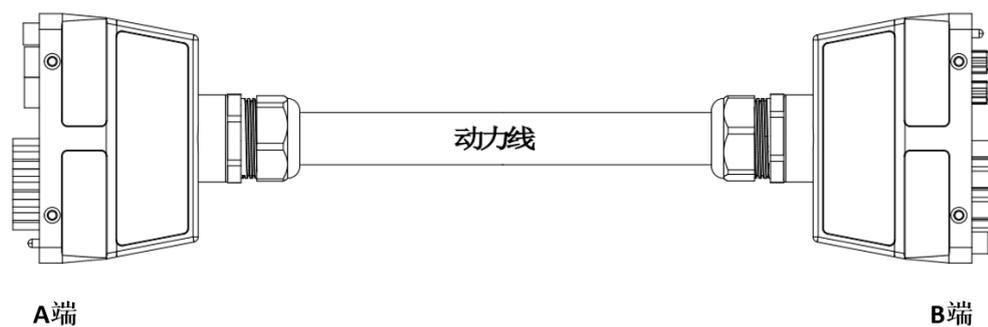
图 4-6 ARC4-50 动力线示意图
