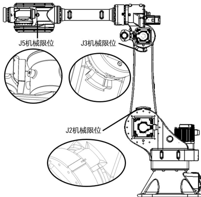
图 6-2 AIR50-2230B 操作机上机械式制动器
