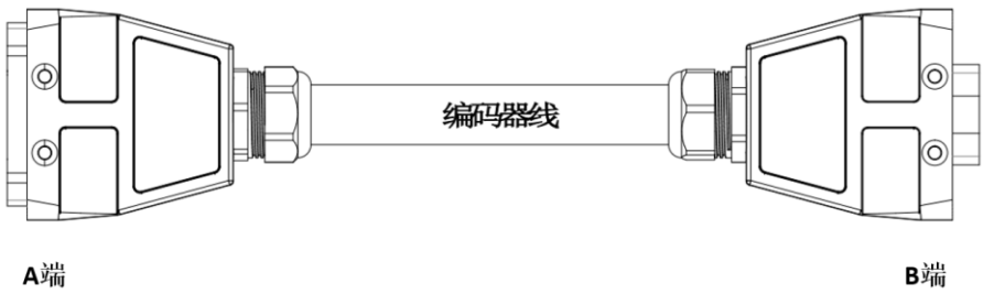
图 3-4 ARC5-280 编码器线示意图
