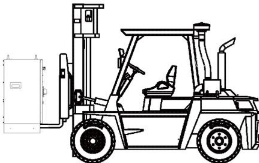
图 2-2 控制柜叉车搬运
