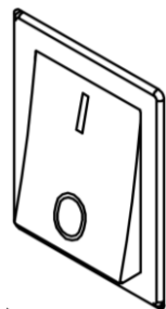
图 3-13 控制柜电源开关
