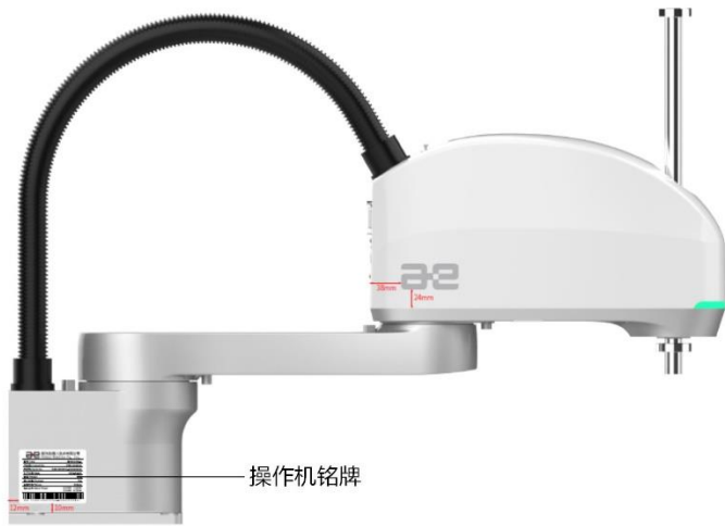
图 2-4 AIR6SC-600A 操作机铭牌位置示意图
