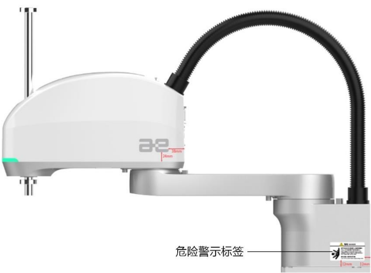
图 2-6 AIR6SC-600A 操作机危险警示标签位置示意图
