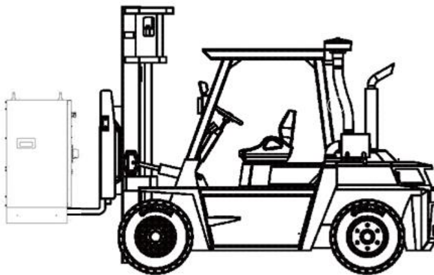
图 2-2 控制柜叉车搬运
