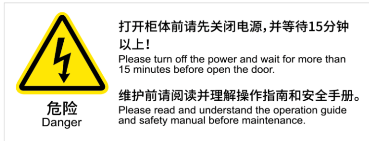
图 1-6 开门断电&amp;维护指示牌
