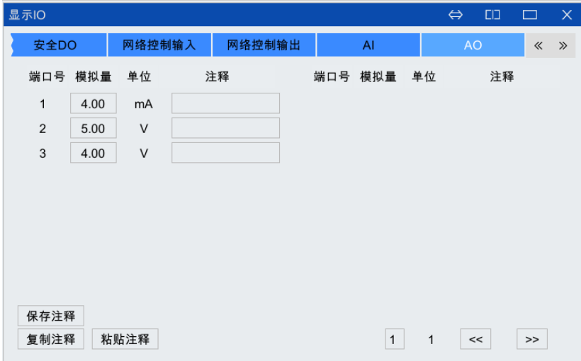
图 6-36 【AO】界面中模拟量实时显示
