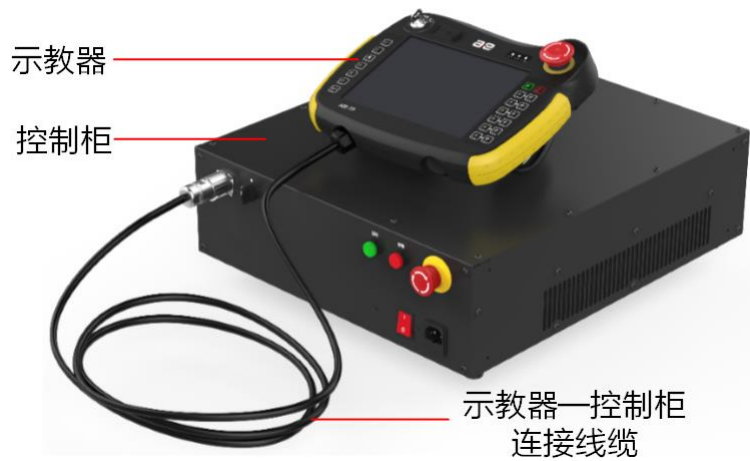
图 2-1 机器人示教器放置位置及方式
