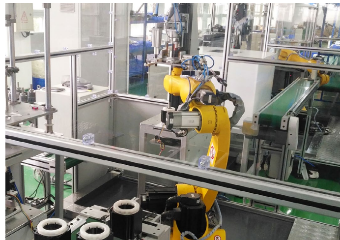
电机装配自动化产线 Motor assembly automation line
