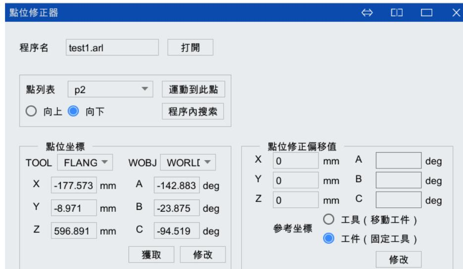
圖 5-96 通過[點位修正偏移值]區域框修改點位坐標
