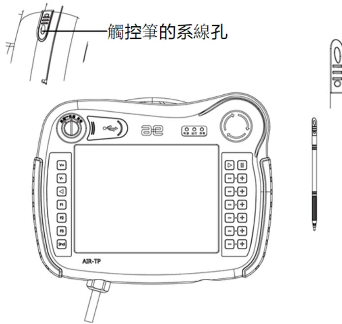
圖 2-14 AIR-TP 示教器觸控筆
