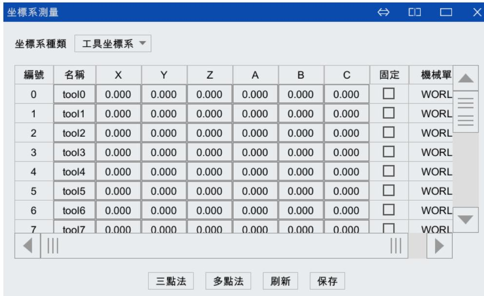
圖 5-59 輸入法設置工具坐標系頁面
