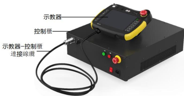
圖 2-1 機器人示教器放置位置及方式
