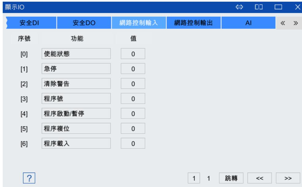
圖 6-29 【網路控制輸入】顯示界面
