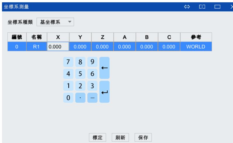
圖 5-83 輸入法設置基坐標系頁面
