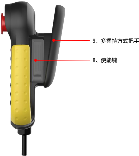
图 2-6 示教器组成部件示意图
