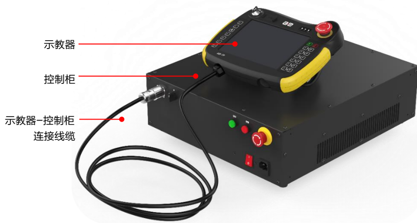
图 2-1 机器人示教器放置位置及方式
