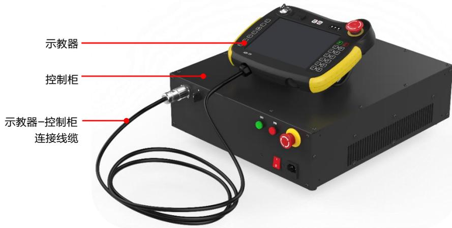
图 2-1 机器人示教器放置位置及方式
