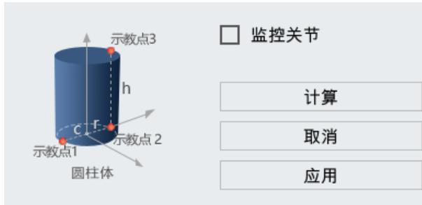
图 6-47 圆柱体工作区域模型示意
