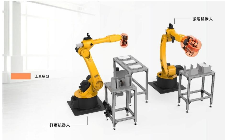
图 6-32 两台机器人协同工作示意图
