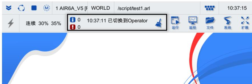
图 8-30 消息栏显示已经切换至操作员权限
