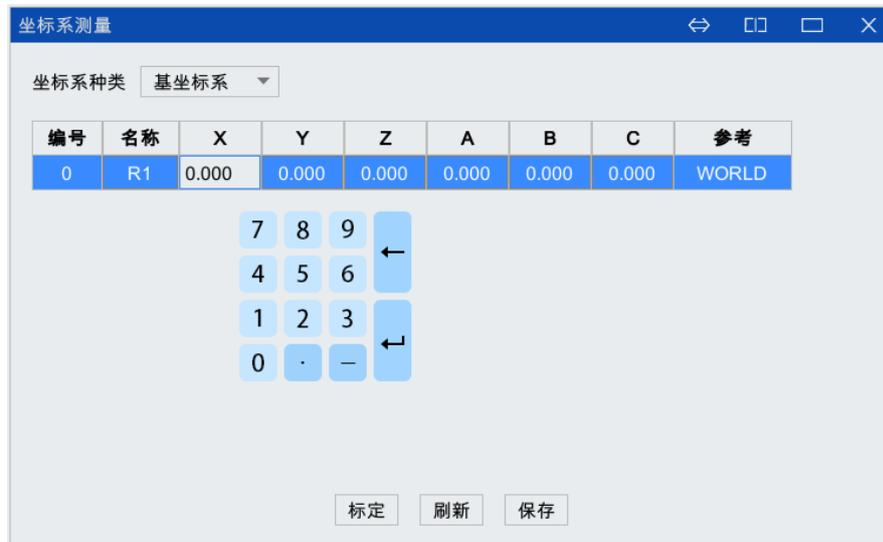
图 5-83 输入法设置基坐标系页面
