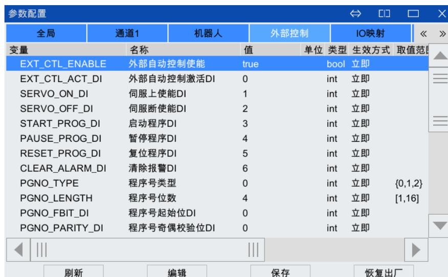
图 6-15 【参数配置】中的【外部控制】选项卡
