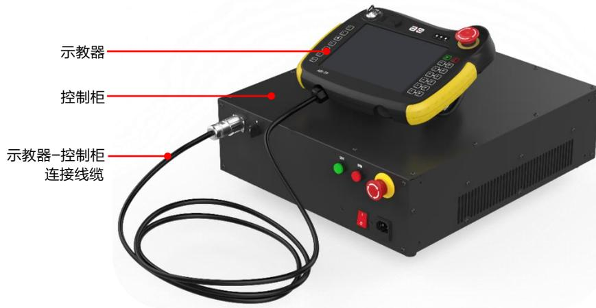
图 2-1 机器人示教器放置位置及方式
