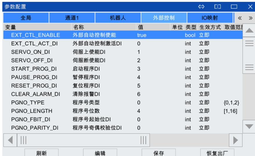
图 6-23 【参数配置】中的【外部控制】选项卡
