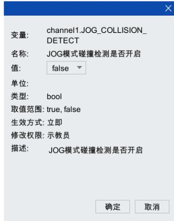
图 10-4 参数 JOG\_COLLISION\_DETECT 编辑界面
