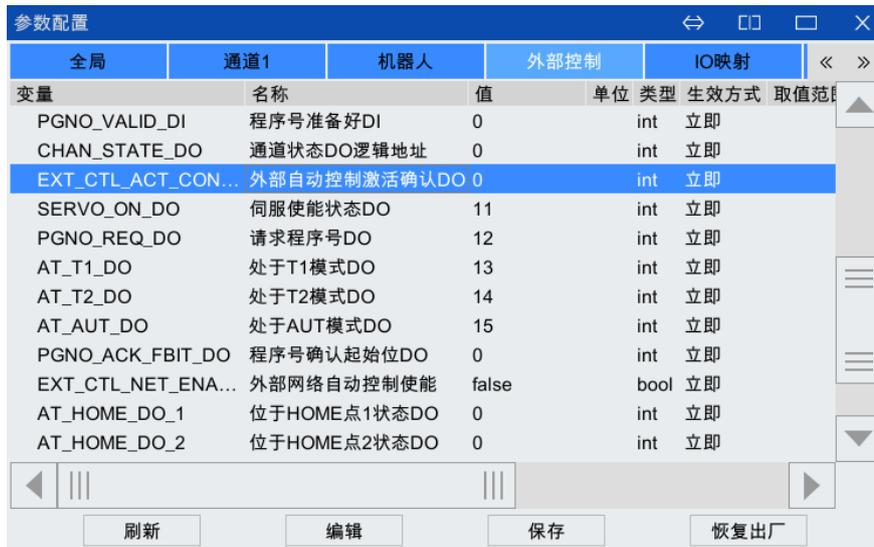
图 6-19 【参数配置】中的【外部控制】选项卡
