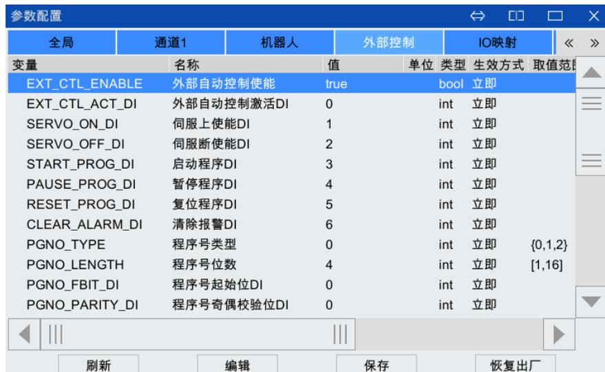
图 6-7 【参数配置】中的【外部控制】选项卡
