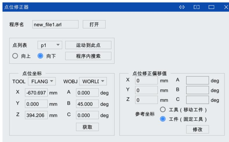
图 5-96 通过[点位修正偏移值]区域框修改点位坐标
