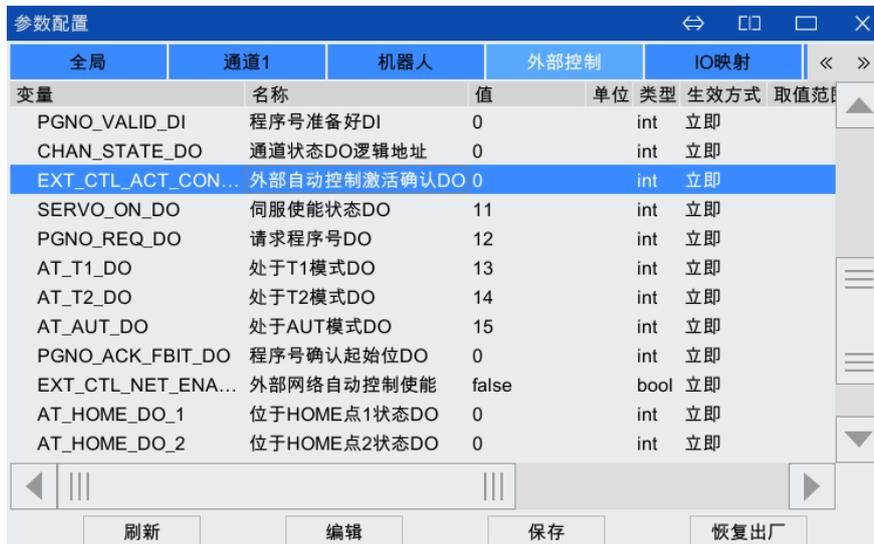
图 6-27 【参数配置】中的【外部控制】选项卡
