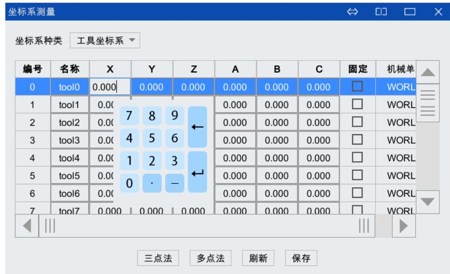
图 5-61 输入法设置工件坐标系页面
