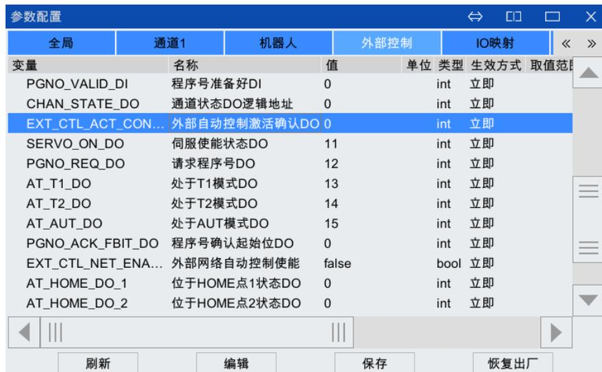
图 6-11 【参数配置】中的【外部控制】选项卡
