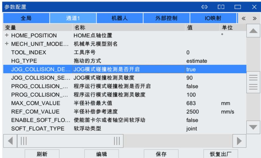
图 10-6 参数 JOG\_COLLISION\_DETECT 设置成功
