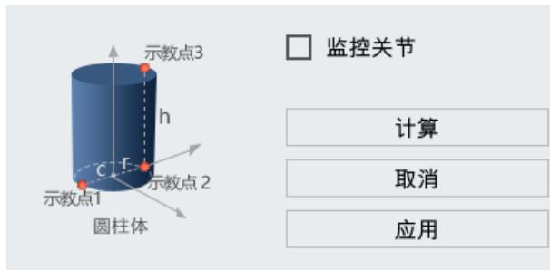
图 6-44 圆柱体工作区域模型示意
