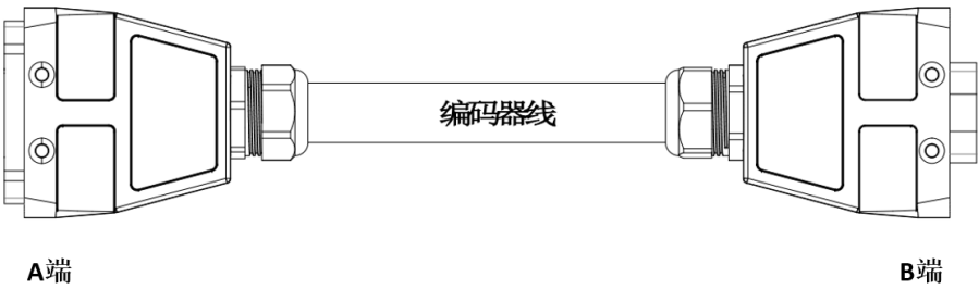
图 9-17 ARC5-280 柜外编码器线束示意图
