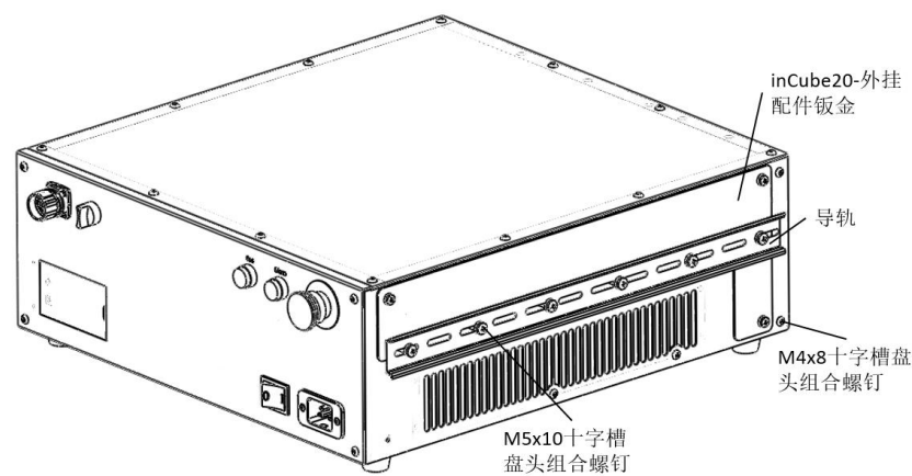
图 16-3 安装 inCube20-外挂钣金与导轨
