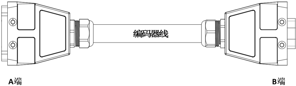
图 9-32 ARC4-50/ARC4-75/ARC4-165 编码器固定线与拖链线外形示意图
