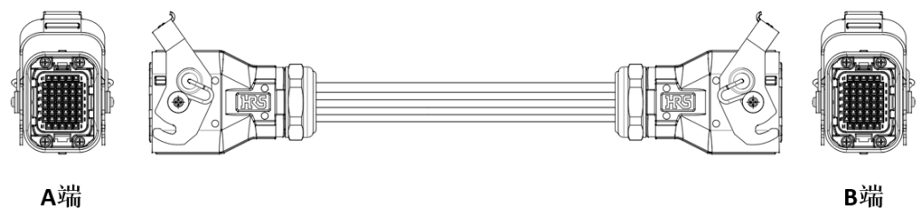
图 9-25 inCube20 重载拖链线外形示意图
