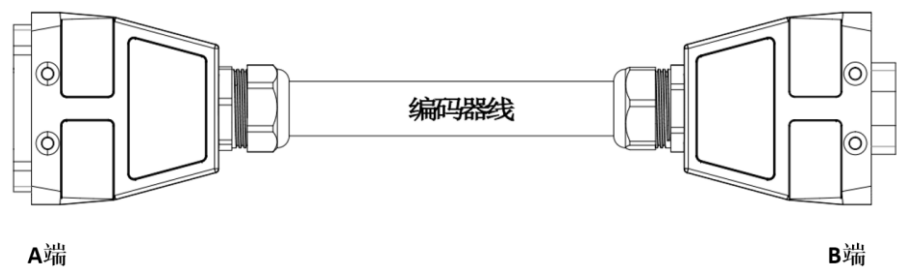
图 9-10 ARC4-50/ARC4-75/ARC4-165 编码器线示意图
