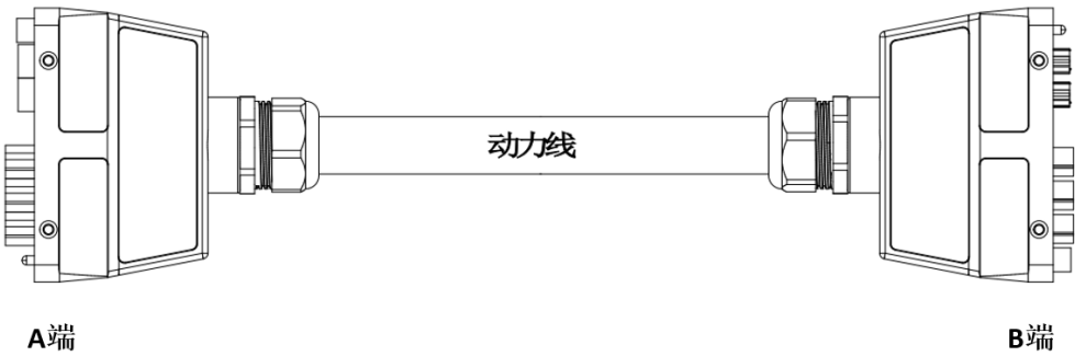
图 9-12 ARC4-50/ARC4-75 动力线示意图
