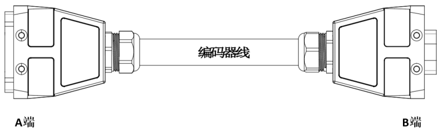
图 9-20 ARC5-280 编码器拖链线示意图
